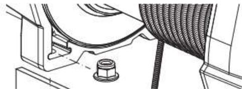
5. Enrosque a extremidade da alça de gancho da corda através da abertura do suporte de montagem e do folheado
