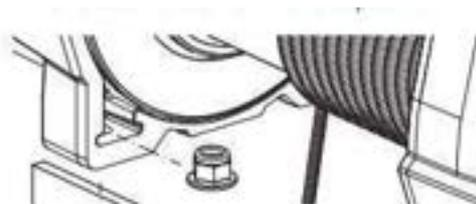
5. Enrosque a extremidade da alça de gancho da corda através da abertura do suporte de montagem e do folheado.
